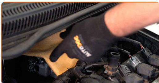
12 Instale la tapa del filtro de aire. Fijela.
