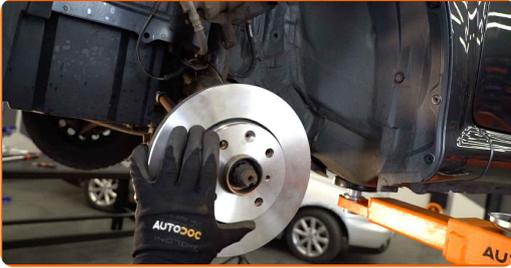
**19** Apriete la fijación del disco de freno. Utilice un destornillador Phillips. Utilice una llave dinamométrica. Apriételo a un par de 5 Nm.
