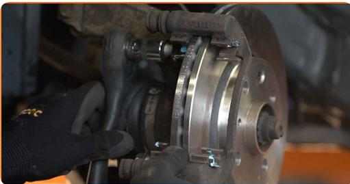
**21** Apriete la fijación de la pinza del cáliper de freno. Use un vaso de impacto del n.º 17. Utilice una llave dinamométrica. Apriételo a un par de 88 Nm.
