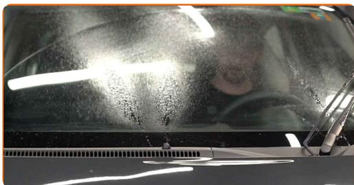
6 Después de la instalación verifique el funcionamiento del limpiaparabrisas. Las escobillas no deben cruzarse o chocar con la compactación del cristal.
