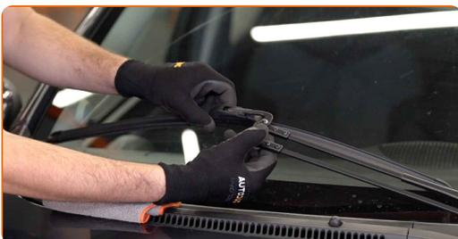
**3** Presione el clip de fijación. Utilice un destornillador plano. Retire la escobilla del brazo del limpiaparabrisas.
