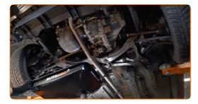
Destornille el tapón de desagüe. Use un vaso de impacto del n.º 15. Utilice una llave de trinquete.
