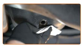
Atornille en el nuevo tapón de drenaje y apriételo. Use un vaso de impacto del n.º 15. Utilice una llave 15 dinamométrica. Apriételo a un par de torsión de 27 Nm.
