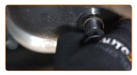
Limpie el área del orificio de drenaje de la bandeja de aceite. Utilice un spray de limpieza multiuso. 16
