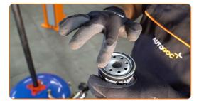
Atornille el filtro nuevo en su sitio. Utilice el vaso 76/14-F. Utilice una llave dinamométrica. Apriételo a un par de torsión de 23 Nm.
