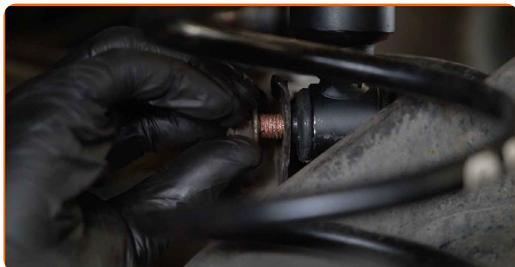
**33** Apriete la fijación inferior del amortiguador. Use un vaso de impacto del n.º 16. Utilice una llave dinamométrica. Apriételo a un par de 70 Nm.
