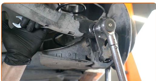
**30** Instale el perno de sujeción.
