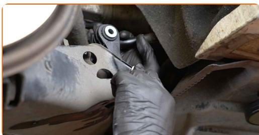
**31** Apriete la sujeción que conecta la barra estabilizadora con el brazo de control. Usa una llave mixta del n.º 16. Use un vaso de impacto del n.º 16. Utilice una llave dinamométrica. Apriételo a un par de 40 Nm.
