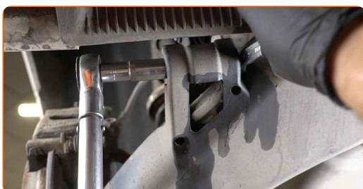
**32** Instale el perno de sujeción.
