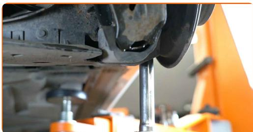
**29** Apriete la sujeción que conecta el brazo de suspensión a la mangueta trasera. Usa una llave mixta del n.º 18. Use un vaso de impacto del n.º 18. Utilice una llave dinamométrica. Apriételo a un par de 85 Nm.
