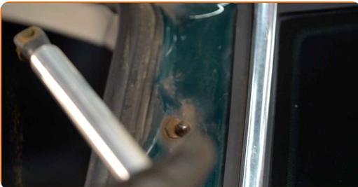
6 Instale el nuevo amortiguador de gas de la puerta del maletero.
