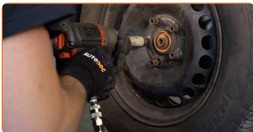
**26** Baje el automóvil y, manteniendo el orden cruzado, apriete los pernos de fijación de las ruedas. Utilice una llave dinamométrica. Apriételo a un par de 120 Nm.
