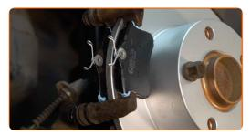
Establezcan el soporte de freno y lo fijen. Use un vaso de impacto del n.º 13. Usa una llave mixta del n.º 15. Utilice una llave dinamométrica. Apriételo a un par de 35 Nm.
