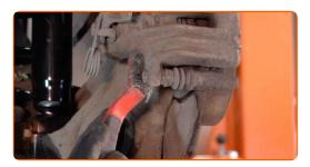
Destornille la fijación del cáliper de freno. Usa una llave mixta del n.º 13. Usa una llave mixta del n.º 15. Utilice una llave de trinquete.
