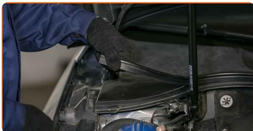
**29** Retire los clips de la rejilla de ventilación plástico del capó.
