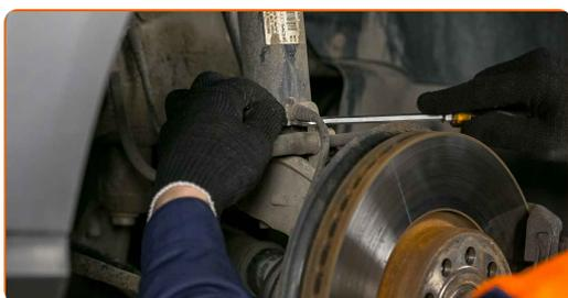
**7** Desconecten el punto de separación eléctrico del sensor ABS. Utilice un destornillador plano.
