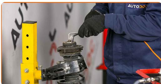
**Sustitución: copelas del amortiguador - VW Passat Variant B6. Consejo de AUTODOC:**
