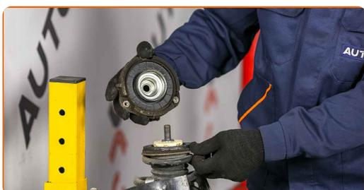
Sustitución: copelas del amortiguador - VW Passat 3C5. Consejo de los expertos de AUTODOC:
