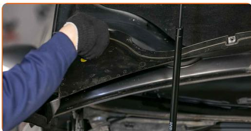
**31** Limpie las sujeciones del soporte superior del puntal amortiguador. Use un cepillo de alambre. Use el aerosol WD-40.
