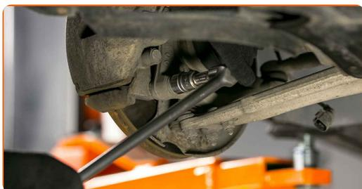
**10** Retire la pinza del freno junto con su soporte.
