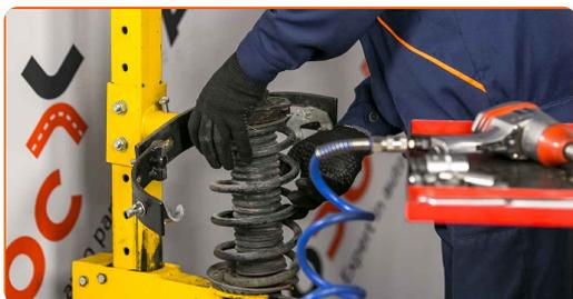
Sustitución: copelas del amortiguador - VW Passat 3C B6 Variant. Consejo:
