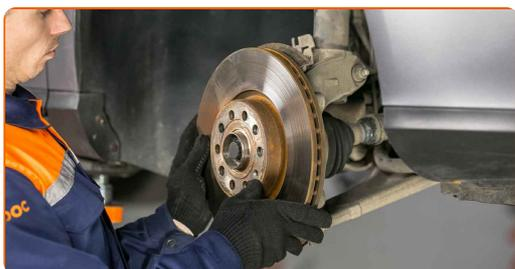
**59** Apriete la fijación del disco de freno. Utilice Torx T30. Utilice una llave dinamométrica. Apriételo a un par de 4 Nm.
