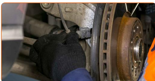
**8** Limpie las sujeciones del soporte de la pinza del freno. Use un cepillo de alambre. Use el aerosol WD-40.
