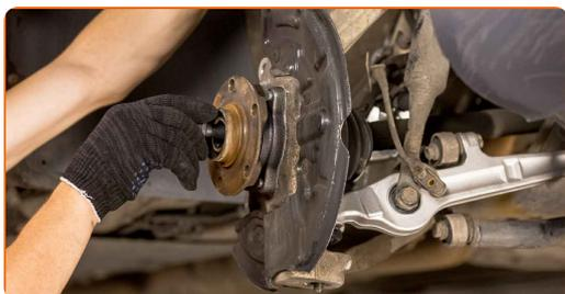
**33** Conecte el brazo de control superior a la mangueta de dirección. Utilice un martillo.
