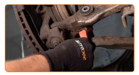
37 Instale la pata amortiguadora en el arco de la rueda.
