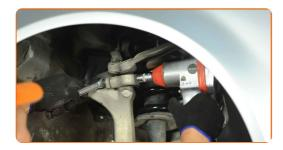
Sostenga el muñón de dirección. Utilice un gato de transmisión hidráulica.
