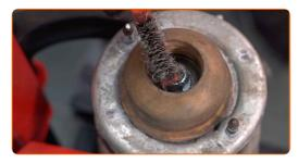
Destornille la tuerca de la varilla de la pata amortiguadora. Use un vaso de impacto del n.º 18. Utilice una llave de trinquete.
