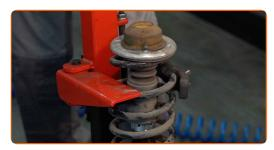
Trate la varilla del amortiguador. Use un cepillo de alambre. Use el aerosol WD-40.
