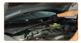
Quite la tapa del soporte del amortiguador. Utilice un destornillador plano.
