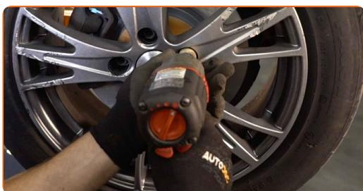
**34** Baje el automóvil y, manteniendo el orden cruzado, apriete los pernos de fijación de las ruedas. Utilice una llave dinamométrica. Apriételo a un par de 120 Nm.
