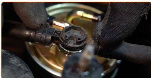
18 Instale el retenedor del tubo del filtro de combustible.
