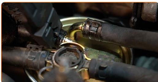
20 Apriete las abrazaderas de sujeción de los tubos del filtro de combustible. Utilice alicates para abrazaderas de manguera con retenedor.
