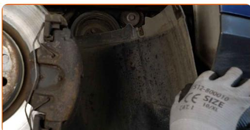
6 Tire hacia un lado la polea tensora de la correa acanalada en V. Usa una llave mixta del n.º 16.
