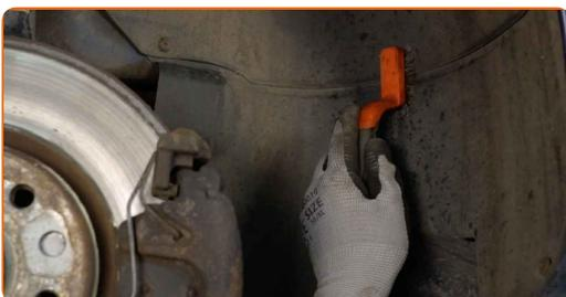
4 Desatornille las sujeciones del protector de paso de rueda. Utilice Torx T25. Utilice una llave de trinquete.
