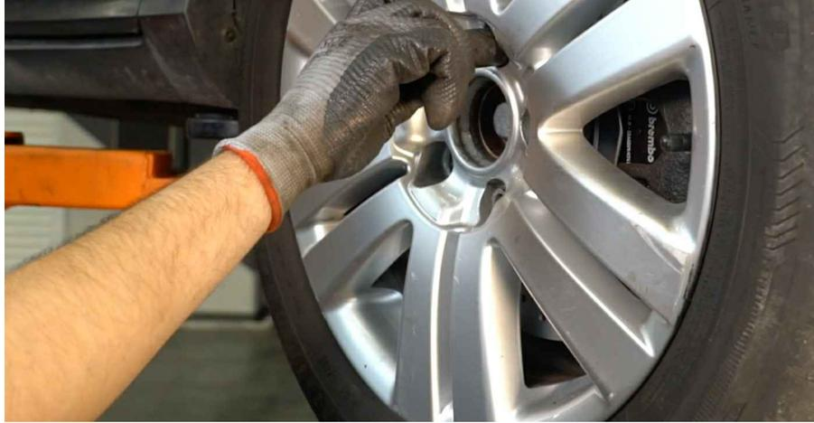
35 Baje el automóvil y, manteniendo el orden cruzado, apriete los pernos de fijación de las ruedas. Utilice una llave de impacto para llanta # 17. Utilice una llave dinamométrica. Apriételo a un par de 120 Nm.
