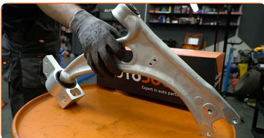
Sustitución: brazo inferior de la parte delantera - VW Passat Variant B6.
