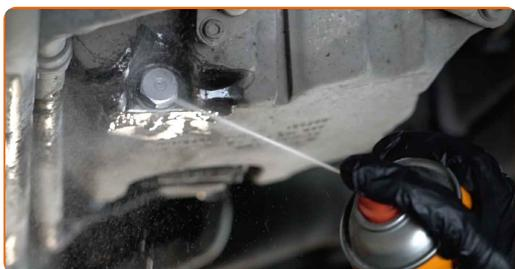
**4** Destornille el tapón de desagüe. Use un vaso de impacto del n.º 19. Utilice una llave de trinquete.
