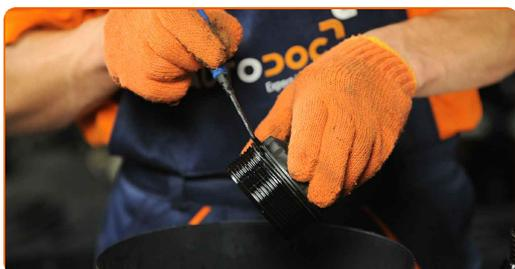
**16** Instale una nueva junta tórica en el asiento de montaje de la cubierta del filtro. Utilice un destornillador plano.
