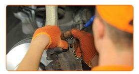
Quite los tapones de los guardapolvos de las guías del cáliper. Utilice un destornillador plano.
