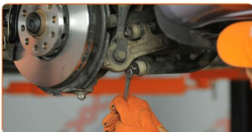
**16** Retire el perno de sujeción.
