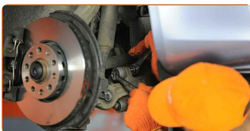
**15** Desatornille la sujeción que conecta la bieleta a la barra estabilizadora. Use una llave mixta del n.º 16.
