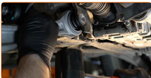
**30** Instale el perno de sujeción. Utilice un martillo. Use un punzón.
