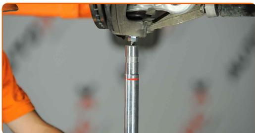
**40** Apriete la fijación inferior de la pata amortiguadora. Use una llave mixta del n.º 18. Use un vaso de impacto del n.º 18. Utilice una llave dinamométrica. Apriételo a un par de 90 Nm.
