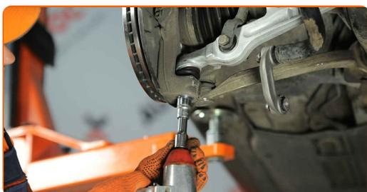
**35** Instale la barra del estabilizador de estabilidad transversal.
