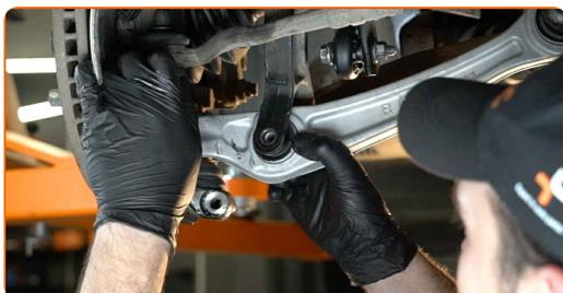
**33** Instale el perno de sujeción.
