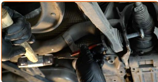
**21** Separe el brazo de control. Use una palanca.
