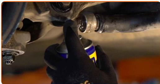
**14** Desenrosque la sujeción que conecta la barra estabilizadora con el brazo de control. Use una llave mixta del n.º 13. Use una llave mixta del n.º 16.
