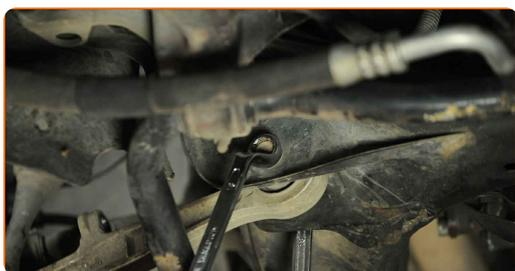
**20** Retire el perno de sujeción.
