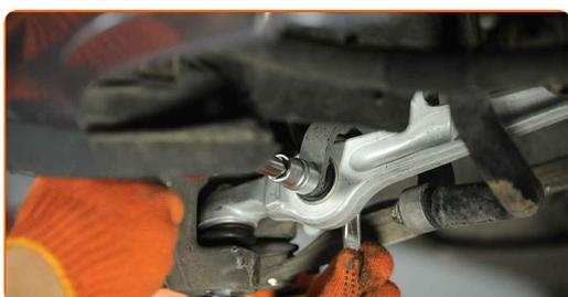
**41** Apriete la fijación de la palanca al bastidor auxiliar. Use una llave mixta del n.º 18 (2 piezas). Utilice una llave dinamométrica. Apriételo a un par de 70 Nm.+180°
