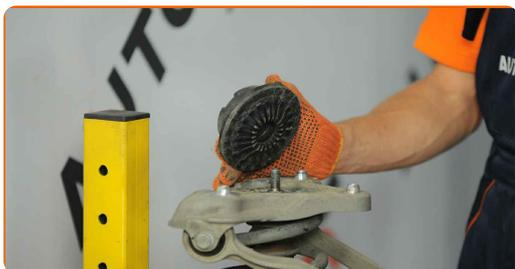
Sustitución: copelas del amortiguador - Audi A4 B7 Avant. Consejo de AUTODOC:
