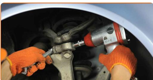
**10** Retire el perno de sujeción.
