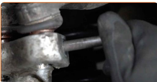
**11** Desconecte el brazo de control superior de la mangueta de dirección. Utilice un cincel de metal plano. Utilice un martillo.
