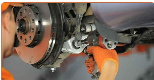
**8** Retire el perno de sujeción.
