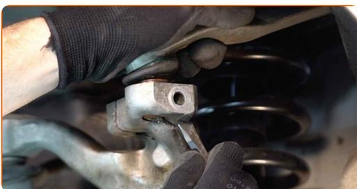
**41** Instale el perno de sujeción. Utilice un martillo. Use un punzón.
