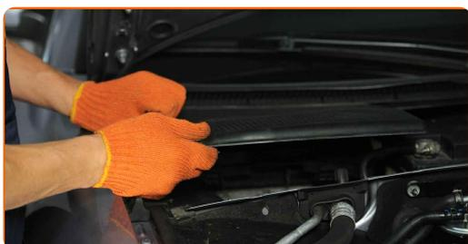
**18** Quite la tapa de protección del soporte del amortiguador. Utilice un destornillador plano.
