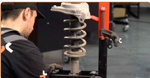
Sustitución: copelas del amortiguador - Audi A4 B7 Avant. Consejo de los expertos de AUTODOC:
