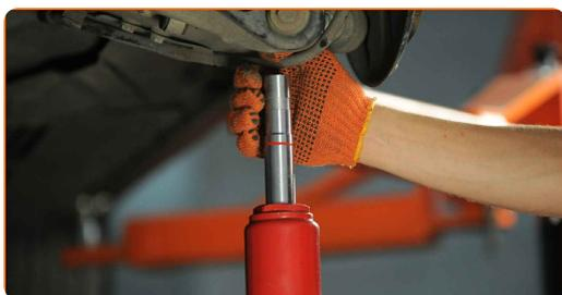
**11** Retire el perno de sujeción.
