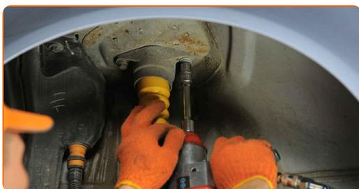
**Sustitución: copelas del amortiguador - Audi A4 B7 Avant. Consejo:**
