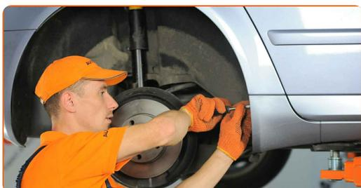
**7** Retire la cubierta del paso de rueda.
