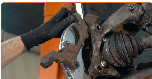
**27** Apriete la fijación de la pinza del cáliper de freno. Use un vaso de impacto del n.º 21. Utilice una llave dinamométrica. Apriételo a un par de 175 Nm.
