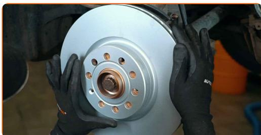
**24** Apriete la fijación del disco de freno. Utilice Torx T30. Utilice una llave dinamométrica. Apriételo a un par de 4 Nm.
