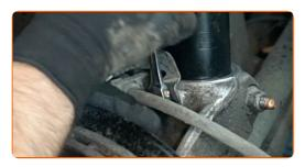
Apriete la fijación inferior de la pata amortiguadora. Use un vaso de impacto del n.º 18. Utilice las puntas XZN #14. Utilice una llave de trinquete. Utilice una llave dinamométrica. Apriételo a un par de 70 Nm.+90°
