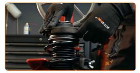
Apriete la tuerca de la varilla de la pata amortiguadora. Use un vaso de impacto del n.º 21. Use Vaso HEX No. H7. Utilice una llave dinamométrica. Apriételo a un par de 60 Nm.
