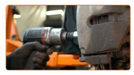
Retire el perno de sujeción.
