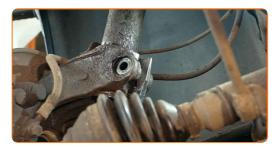
Desconecte el muñón de dirección de la pata amortiguadora.
