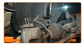
Desatornille las sujeciones superiores del amortiguador.
