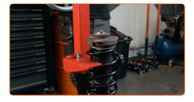
Retire el puntal amortiguador que está montado.
