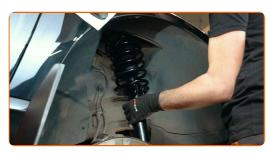
Fije las sujeciones superiores del puntal amortiguador. No lo apriete.
