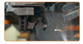
Apriete las sujeciones que conectan la rótula al brazo de control. Use un vaso de impacto del n.º 16. Utilice una llave dinamométrica. Apriételo a un par de 60 Nm.
