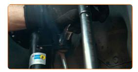
Instale y apriete el perno del eje de transmisión. Use un vaso de impacto del n.º 27. Utilice una llave de trinquete.
