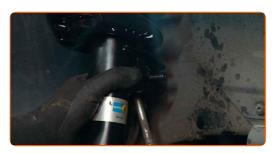
Apriete la sujeción que conecta la bieleta de barra estabilizadora al amortiguador. Usa una llave mixta del n.º 18. Use un vaso de impacto del n.º 18. Utilice las puntas XZN #6. Utilice una llave dinamométrica. Apriételo a un par de 55 Nm.
