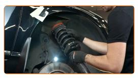
Instale la pata amortiguadora en el mecanismo para apretar los resortes.
