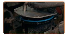
Saquen el filtro de combustible. Utilice un destornillador plano.
