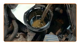
Limpie la carcasa del filtro de combustible y la cubierta.
