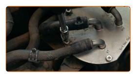
Retire la cubierta de la carcasa del filtro de combustible. Utilice un destornillador plano.
