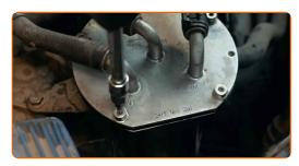
Apriete las sujeciones de la tapa de la carcasa del filtro de combustible. Utilice Torx T15. Utilice una llave dinamométrica. Apriételo a un par de 6 Nm.
