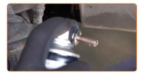
Instale una nueva bieleta de suspensión y apriete las sujeciones. Use un vaso de impacto del n.º 17. Utilice una llave de trinquete.
