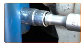
Desatornille la sujeción que conecta la bieleta a la barra estabilizadora. Usa una llave mixta del n.º 17. Use Vaso HEX No. H6. Utilice una llave de trinquete.
