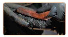
Trate la rosca de las sujeciones de la barra estabilizadora. Use grasa de cobre.
