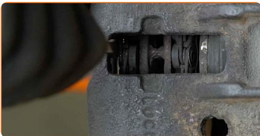
**9** Desenrosque las sujeciones de la pinza de freno. Usa una llave mixta del n.º 13. Usa una llave mixta del n.º 15.
