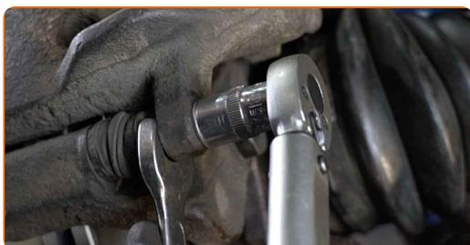
**36** Trate la superficie donde el disco del freno entra en contacto con la llanta de la rueda. Utilice grasa cerámica.
