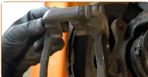
**17** Limpie las sujeciones del disco de freno. Use un cepillo de alambre. Use el aerosol WD-40.
