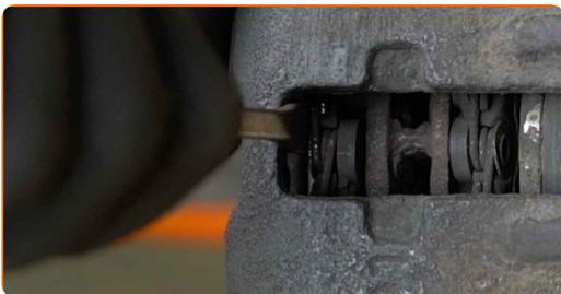
**9** Desenrosque las sujeciones de la pinza de freno. Use una llave mixta del n.º 13. Use una llave mixta del n.º 15.
