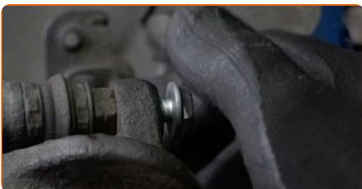
**20** Apriete las sujeciones de la pinza del freno. Usa una llave mixta del n.º 13. Usa una llave mixta del n.º 15. Utilice una llave dinamométrica. Apriételo a un par de 27 Nm.
