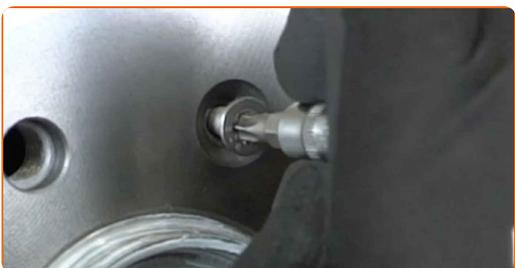
**30** Apriete las sujeciones del tambor del freno. Utilice Torx T30. Utilice una llave dinamométrica. Apriételo a un par de 10 Nm.
