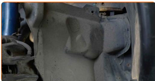
**21** Instale y apriete las sujeciones de la cubierta del paso de rueda. Utilice una herramienta de extracción de clips. Utilice un destornillador Phillips.
