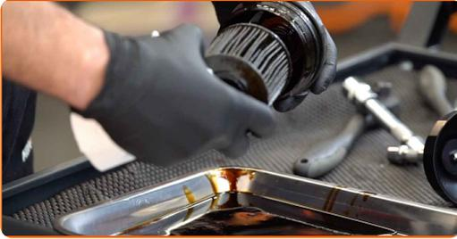
13 Retire las juntas tóricas viejas de la tapa del filtro de aceite. Utilice un destornillador plano.
