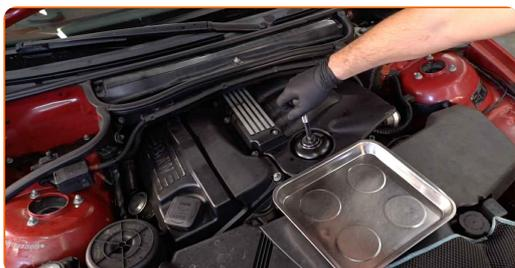
20 Atornille la tapa. Utilice el vaso 86/16 F. Utilice una llave dinamométrica. Apriételo a un par de 25 Nm.
