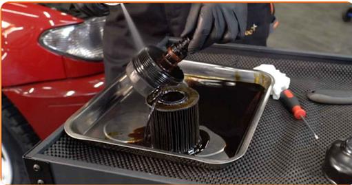
15 Instale nuevas juntas tóricas y un nuevo filtro de aceite en los asientos de montaje de la tapa del filtro.
