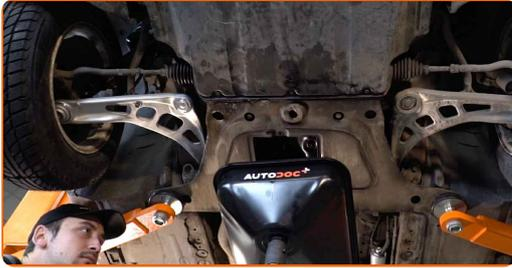
6 Destornille el tapón de desagüe. Use un vaso de impacto del n.º 17. Utilice una llave de trinquete.
