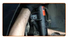
Apriete la sujeción que conecta la bieleta de barra estabilizadora al amortiguador. Usa una llave mixta del n.º 18. Use un vaso de impacto del n.º 15. Utilice una llave dinamométrica. Apriételo a un par de 58 Nm.
