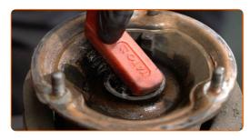
Destornille la tuerca de la varilla de la pata amortiguadora. Use un vaso de impacto del n.º 21. Use Vaso HEX No. H6. Utilice una llave de trinquete.
