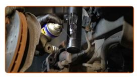
Fije la pata amortiguadora en el muñón de dirección.
