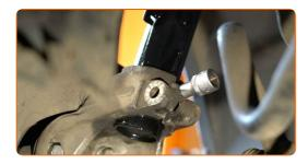
53 Instale el perno de sujeción.
