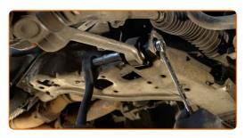
Limpie las sujeciones que conectan el puntal amortiguador a la mangueta de dirección. Use un cepillo de alambre. Use el aerosol WD-40.
