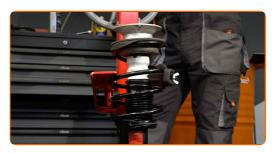
Retire el puntal amortiguador que está montado.
