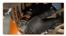
Atornille la tuerca de sujeción que conecta el extremo de la barra de acoplamiento a la mangueta de dirección. Use un vaso de impacto del n.º 21. Utilice una llave de trinquete.
