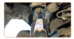
Desatornille la sujeción inferior que conecta el puntal amortiguador a la mangueta de dirección. Usa una llave mixta del n.º 18. Use un vaso de impacto del n.º 18. Utilice una llave de trinquete.
