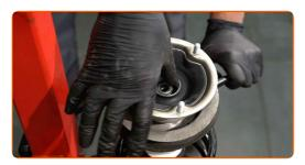
Apriete la tuerca de la varilla de la pata amortiguadora. Use un vaso de impacto del n.º 21. Use Vaso HEX No. H6. Utilice una llave dinamométrica. Apriételo a un par de 64 Nm.
