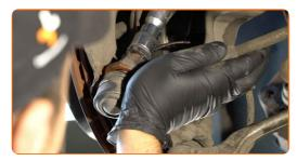
61 Instale la pinza del freno junto con su soporte.
