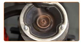
Instale la tapa del soporte del amortiguador.
