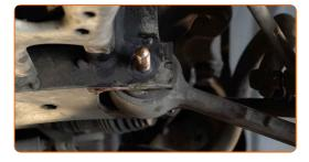
Limpie los asientos de montaje del extremo de la barra de acoplamiento. Use un cepillo de alambre. Use el aerosol WD-40.
