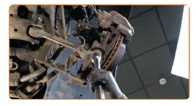
Apriete la sujeción trasera del brazo de control. Usa una llave mixta del n.º 18. Use un vaso de impacto del n.º 18. Utilice una llave dinamométrica. Apriételo a un par de 68 Nm.+90°
