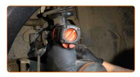
Retire el enlace estabilizador de estabilidad transversal.
