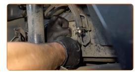
14 Suelte el conector del sensor ABS.
