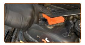
Afloje la sujeción superior del soporte del amortiguador. Usa una llave mixta del n.º 13.
