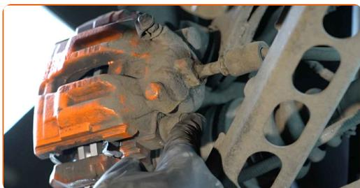
**35** Conecte el captador de desgaste de las pastillas de freno.
