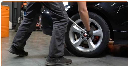
**7** Levante la parte trasera del automóvil y fije la posición sobre los pedestales.
