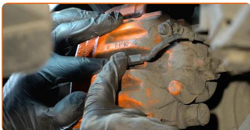
**36** Instale el resorte de fijación del cáliper de freno.
