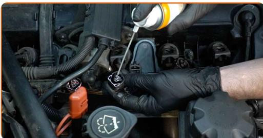
**25** Conecte los conectores de las bobinas del encendido.
