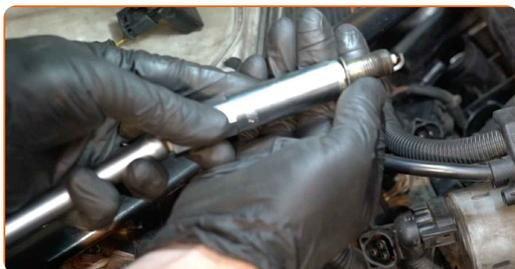
**19** Aplique una capa fina de un lubricante antigripado especial de alta temperatura a las roscas de las nuevas bujías.
