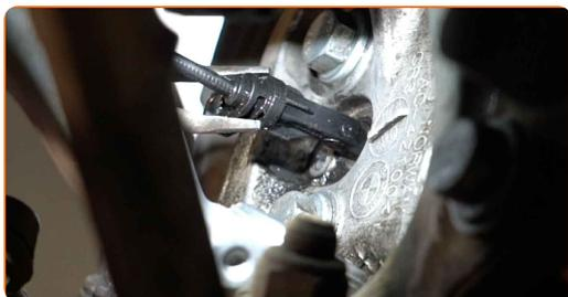
**12** Limpie el asiento de montaje del sensor ABS. Use un cepillo de alambre. Utilice un spray de limpieza multiuso.
