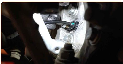
**16** Conecte los cables del captador ABS.
