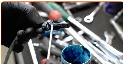
**14** Instale el captador ABS en el muñón de dirección y fíjelo.
