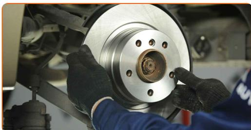
**22** Apriete la fijación del disco de freno. Use Vaso HEX No. H6. Utilice una llave dinamométrica. Apriételo a un par de 16 Nm.
