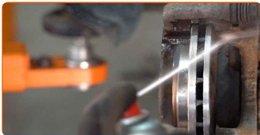
**14** Destornille la fijación de la pinza del cáliper de freno. Use un vaso de impacto del n.º 16. Utilice una llave de trinquete.
