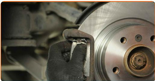
**33** Instale las pastillas de freno. Utilice un destornillador plano.
