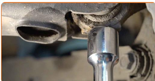
**46** Conecte la parte inferior del amortiguador. Use una palanca. Utilice un destornillador plano.
