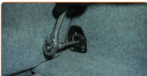
**21** Retire el revestimiento de la parte lateral del maletero.
