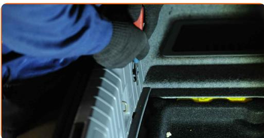
**16** Desatornille las sujeciones del protector de plástico del umbral del maletero. Utilice un destornillador Phillips.
