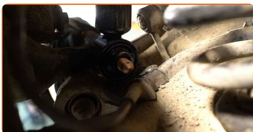
**47** Instale el perno de sujeción.
