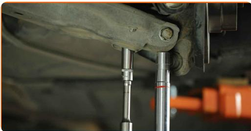
**9** Retire el perno de sujeción.
