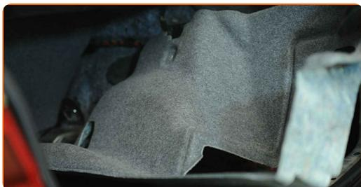
**22** Retire la tapa de protección de la cazoleta del amortizador. Utilice un destornillador plano.
