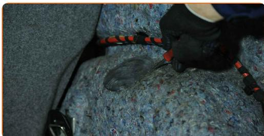
**23** Limpie las fijaciones del soporte de montaje superior del amortiguador. Use un cepillo de alambre. Use el aerosol WD-40.
