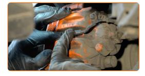
Instale el resorte de fijación del cáliper de freno.
