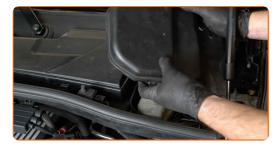
Desatornille el tapón del depósito del líquido de frenos.
