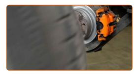
Desconecte el captador de desgaste de las pastillas de freno. Use una palanca.
