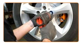
Baje el automóvil y, manteniendo el orden cruzado, apriete los pernos de fijación de las ruedas. Utilice una llave de impacto para llanta # 17. Utilice una llave dinamométrica. Apriételo a un par de 120 Nm.
