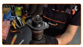
Sujete el amortiguador en un tornillo de banco.
