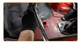
Instale las tapas del montaje del amortiguador. 34
