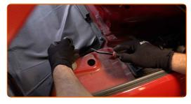
Limpie las fijaciones del soporte de montaje superior del amortiguador. Use el aerosol WD-40.
