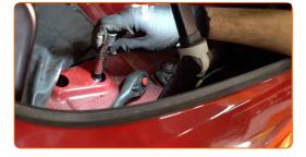
Apriete la fijación inferior del amortiguador. Use un vaso de impacto del n.º 18. Utilice una llave dinamométrica. Apriételo a un par de 100 Nm.
