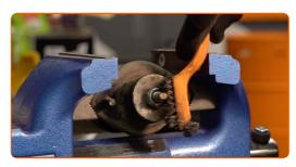
Destornille la fijación de la varilla del amortiguador. Usa una llave mixta del n.º 17.
