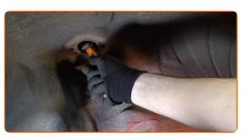
Coloque el amortiguador en el arco de la rueda y fíjelo.
