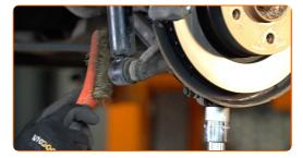
Destornille la fijación inferior del amortizador. Use un vaso de impacto del n.º 18. Utilice una llave giramachos.
