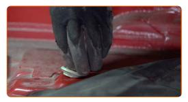
Baje el automóvil y, manteniendo el orden cruzado, apriete los pernos de fijación de las ruedas. Utilice una llave 35 dinamométrica. Apriételo a un par de 120 Nm.
