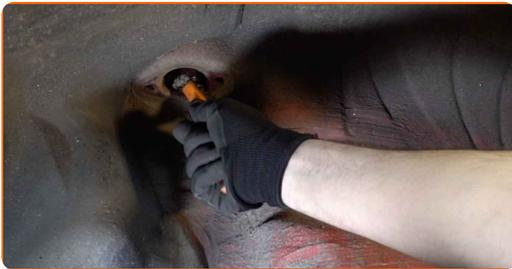
**26** Coloque el amortiguador en el arco de la rueda y fíjelo.
