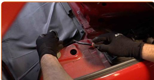
**3** Limpie las fijaciones del soporte de montaje superior del amortiguador. Use el aerosol WD-40.
