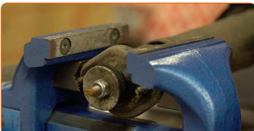
**17** Limpie la sujeción del vástago del amortiguador. Use un cepillo de alambre.
