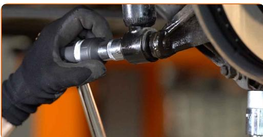
**13** Retire el perno de sujeción.
