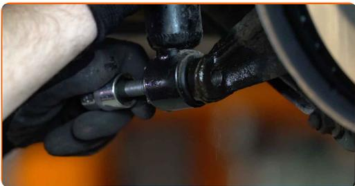
**14** Destornille la fijación superior del amortiguador. Use un vaso de impacto del n.º 13. Utilice una llave de trinquete.
