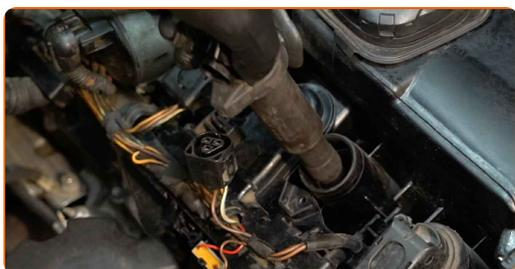
**16** Trate las puntas de la bobina del encendido. Utilice una grasa de alta temperatura. Utilice un destornillador plano.
