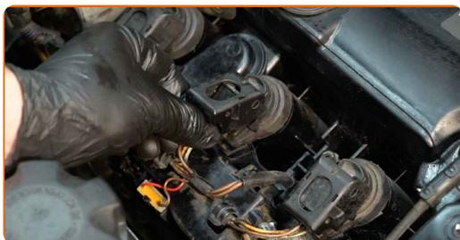
**14** Trate el conector de la bobina de encendido con spray para electrónica. El spray protegerá los contactos eléctricos de la corrosión, oxidación, y reducirá la resistencia de contacto.
