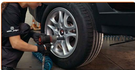
**30** Baje el automóvil y, manteniendo el orden cruzado, apriete los pernos de fijación de las ruedas. Utilice una llave de impacto para llanta # 17. Utilice una llave dinamométrica. Apriételo a un par de 140 Nm.
