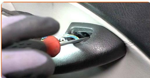
**6** Retire el embellecedor de la placa de la puerta. Utilice una herramienta de recorte de plástico.
