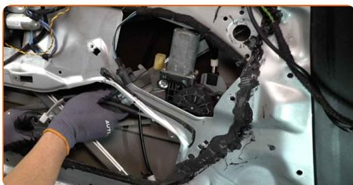
**28** Apriete las sujeciones del ensamblaje del regulador de ventana. Use un vaso de impacto del n.º 10. Utilice una llave dinamométrica. Apriételo a un par de 11 Nm.
