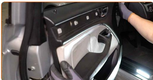
**9** Desconecte el cable del actuador de la cerradura de la puerta.
