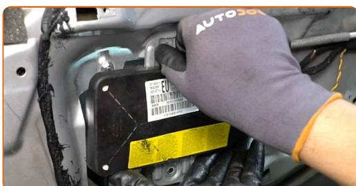
**35** Desmonte el módulo del SRS.
