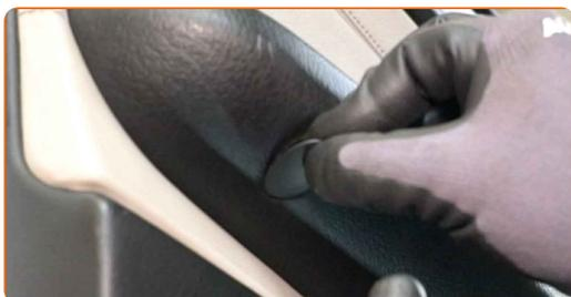
**46** Trate los conectores de control de los espejos retrovisores laterales. Utilice grasa dieléctrica.
