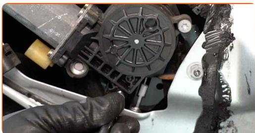
**19** Retire el módulo del interruptor del elevallas eléctrico.
