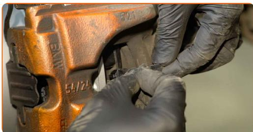
**14** Trate la superficie donde el disco del freno entra en contacto con la llanta de la rueda. Use grasa de cobre.
