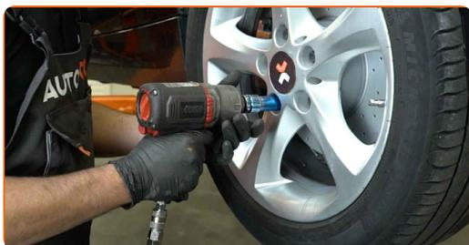
**18** Baje el automóvil y, manteniendo el orden cruzado, apriete los pernos de fijación de las ruedas. Utilice una llave de impacto para llanta # 17. Utilice una llave dinamométrica. Apriételo a un par de 120 Nm.
