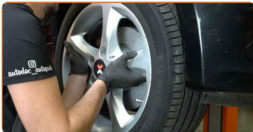
Sustitución: sensor de desgaste de pastillas de frenos - BMW 3 Cabrio (E93).
