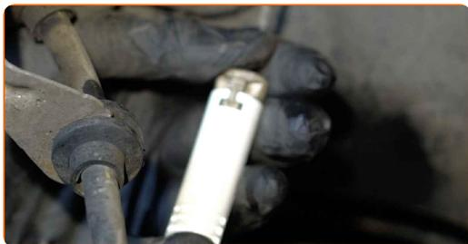
**12** Conecte el captador de desgaste de las pastillas de freno.
