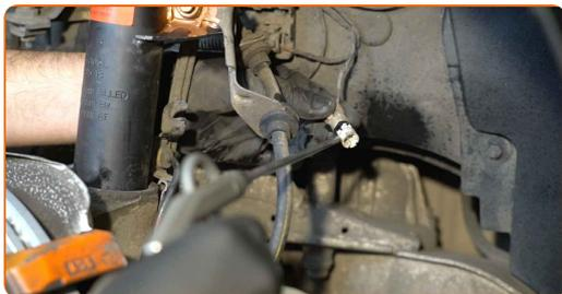
**11** Conecte la clavija del sensor de desgaste de las pastillas de freno.
