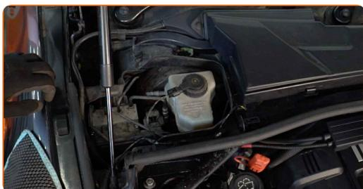
**4** Desatornille el tapón del depósito del líquido de frenos.
