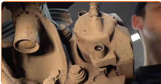
**11** Destornille la fijación del cáliper de freno. Use Vaso HEX No. H7. Utilice una llave de trinquete.
