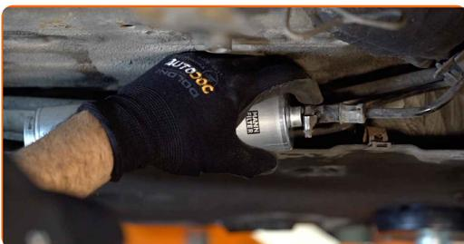
**17** Apriete la fijación de las líneas de admisión del combustible. Utilice un destornillador plano.
