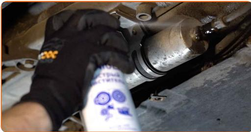
8 Afloje las abrazaderas del filtro de combustible. Utilice un destornillador plano.
