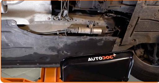
7 Trate las sujeciones que sujetan los tubos al filtro de combustible. Utilice un spray de limpieza multiuso.
