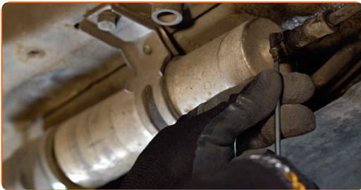
9 Retire el anillo elástico del clip de retención del regulador de presión de combustible.
