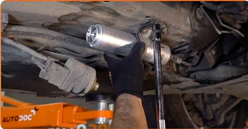
21 Conecte el regulador de presión de combustible al filtro de combustible. Instale el anillo elástico del clip de retención del regulador de presión de combustible.
