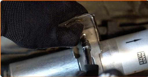
20 Apriete la fijación del filtro de combustible. Use un vaso de impacto del n.º 13. Utilice una llave de trinquete.
