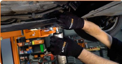
**13** Desatornille la sujeción del soporte del filtro de combustible. Utilice Torx T20. Utilice una llave de trinquete.
