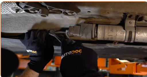
10 Separe el regulador de presión del combustible del filtro de combustible. Use una palanca.
