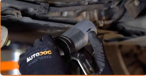
19 Apriete la sujeción del soporte del filtro de combustible. Utilice Torx T20. Utilice una llave de trinquete.
