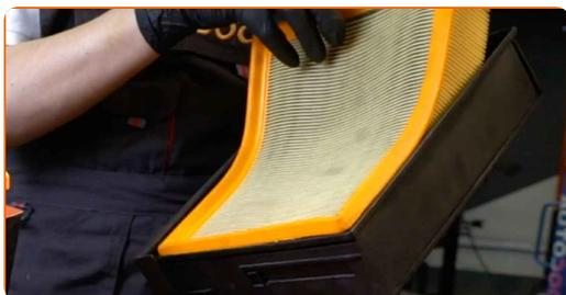
**7** Inserte en la carcasa del filtro el nuevo elemento filtrante. Asegúrese de que el borde del filtro encaje firmemente en la carcasa.
