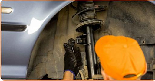
62 Apriete la sujeción que conecta la bieleta de barra estabilizadora al amortiguador. Use un vaso de impacto del n.º 17. Utilice una llave dinamométrica. Apriételo a un par de 60 Nm.
