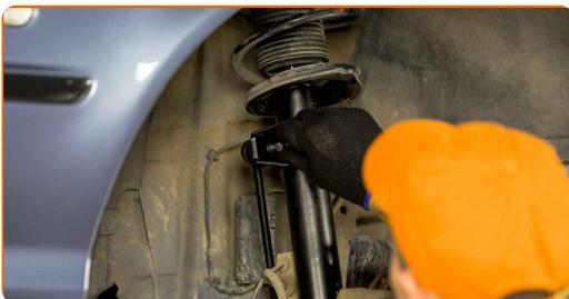
63 Conecte los cables del captador ABS.
