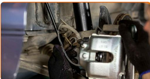
61 Instale la barra del estabilizador de estabilidad transversal.
