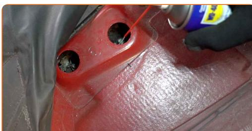
**4** Afloje la sujeción superior del amortiguador. Use un vaso de impacto del n.º 13. Utilice una llave de trinquete.
