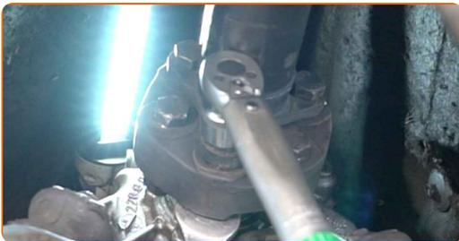
**80** Conecte el rodamiento central del árbol de transmisión a la carrocería.
