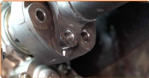
**79** Apriete las sujeciones del acoplamiento del árbol de transmisión. Usa una llave mixta del n.º 18. Use un vaso de impacto del n.º 18. Utilice una llave dinamométrica. Apriételo a un par de 100 Nm.
