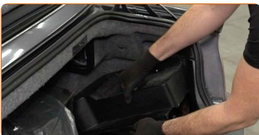
5 Desenrosque la sujeción del borne negativo de la batería. Use un vaso de impacto del n.º 10. Utilice una llave de trinquete.
