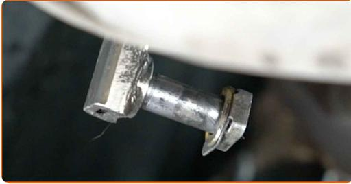
24 Limpie la sujeción del sistema de escape. Use un cepillo de alambre. Use el aerosol WD-40.
