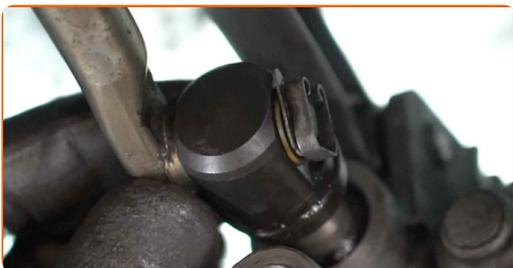
**77** Conecte el árbol de transmisión a la brida del engranaje a través del acoplamiento del árbol de transmisión.
