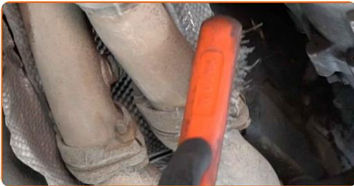
25 Desenrosque las sujeciones del sistema de escape. Usa una llave mixta del n.º 13. Use un vaso de impacto del n.º 13. Utilice una llave de trinquete.
