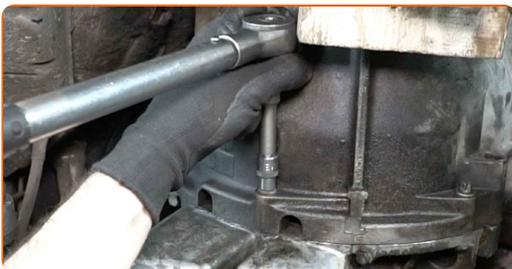
**72** Conecte el brazo de apoyo de la palanca de cambios.
