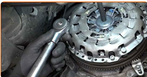
54 Desenrosque la placa de bloqueo de la placa de presión. Use Vaso HEX No. H14. Utilice una llave de trinquete.
