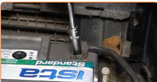
6 Desconecte el terminal del cable de tierra de la batería.
