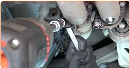
26 Retire la sujeción del sistema de escape.
