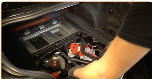
**40** Atornille la sujeción del panel protector central de plástico. Utilice un destornillador Phillips. Utilice Torx T40. Utilice una llave de trinquete.
