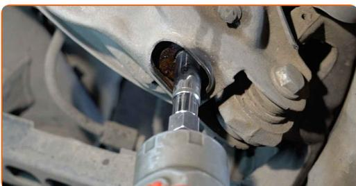
**17** Destornille la fijación superior del amortiguador.
