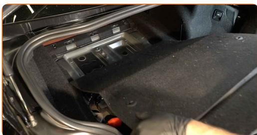
**4** Desenrosque la sujeción del panel de plástico protector central. Utilice un destornillador Phillips. Utilice una herramienta de extracción de clips. Utilice Torx T40. Utilice una llave de trinquete.
