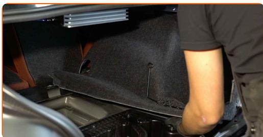
**38** Atornille las sujeciones del revestimiento de la parte lateral del maletero. Utilice Torx T40. Utilice una llave de trinquete.
